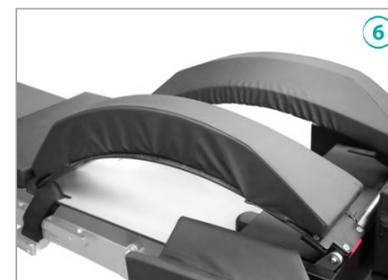
**6. Мостик подъемный для спинальной хирургии** Обеспечивает стабильное и удобное положение для операций на позвоночнике дорсально. Величина изменения прогиба 80 мм, ширина мостика регулируется от 305 мм до 495 мм. Грузоподъемность мостика 50 кг. Мостик оснащен съемными подушками, которые обеспечивают оптимальную безопасность и комфорт пациента. Поставляется в комплекте с подушкой для головы, подушками для рук, полукруглой подушкой, подушкой для колен. Размер (д/ш): 770x510 мм.
