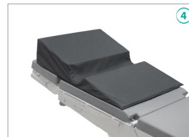
**4. Подушка для позиционирования на боку** Предназначена для операций в положении пациента на боку. Обеспечивает разгрузку и стабилизацию плечевого сустава, защиту нервов в латеральной позиции. Изготовлена из пенополиуретана. Чехол изготовлен из антистатической, «дышащей» ткани. Размер (д/ш/в): 720x500x160 мм.
